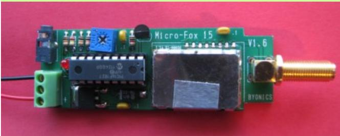
Il Micro-Fox è alloggiato all'interno di un contenitore plastico capace di contenere una batteria da 9V ed il circuito stampato. C'è solo una unità di controllo; un trimmer per il controllo della deviazione, che deve essere regolato in modo che il
